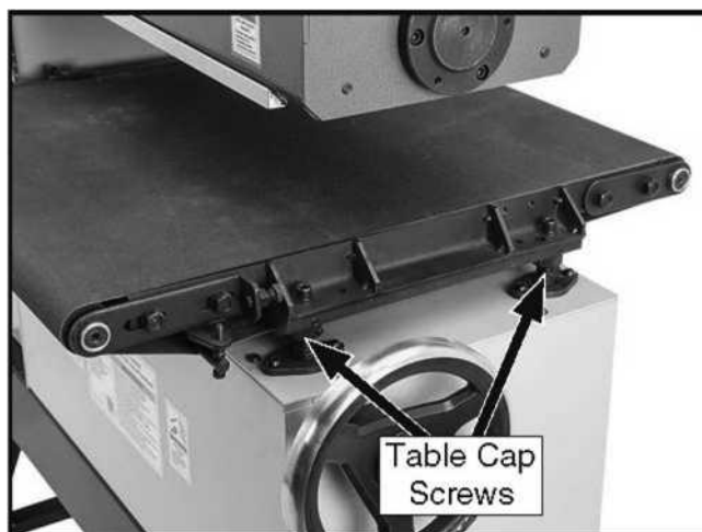
Рисунок 42. Стол для подачи ленты с наружными колпачковыми винтами.
