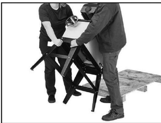
Рисунок 11. Наклоните шлифовальную машину вертикально.
