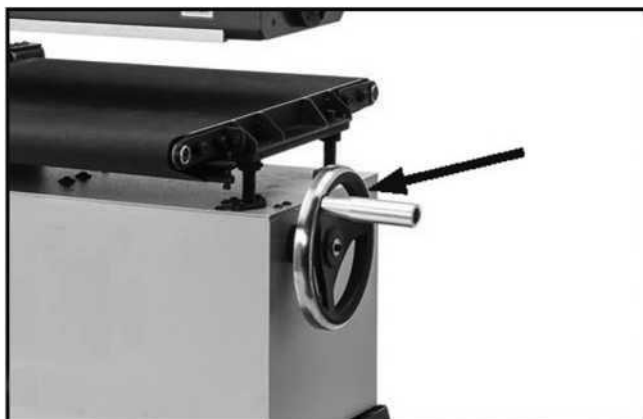
Рисунок 17. Маховик подъема стола.
