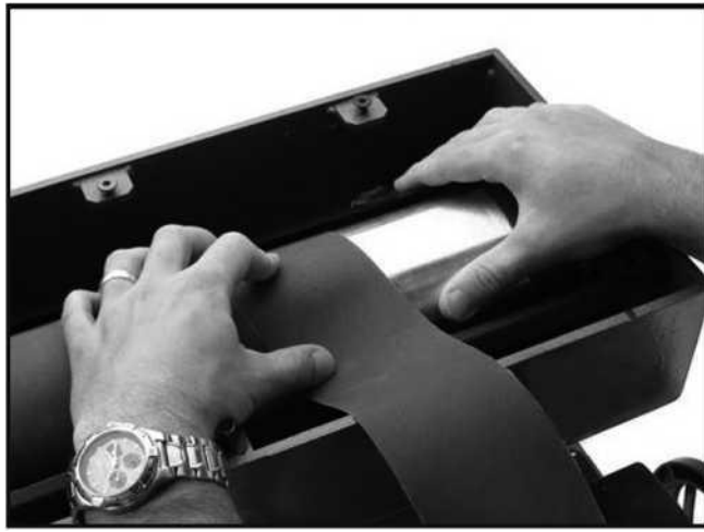
Рисунок 22. Обертывание барабана наждачной бумагой.
