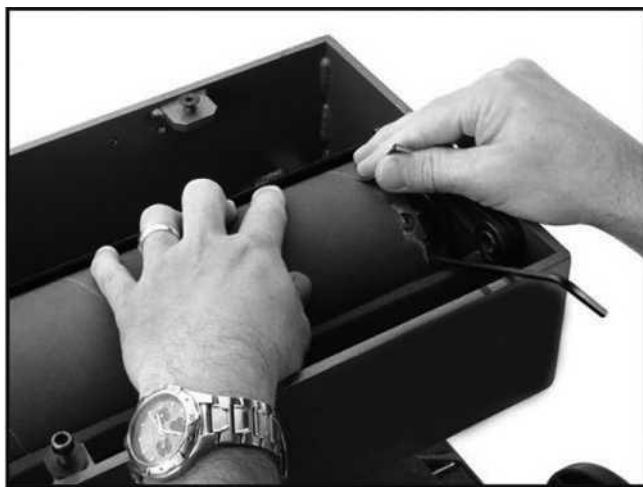
Рисунок 24. Наматываем абразивную ленту на натяжной круг.
